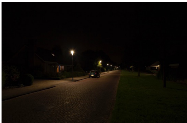
Foto: Keplerlaan; licht is gelijkmatig over de weg verdeeld zodat er geen zwarte vlekken zijn.
