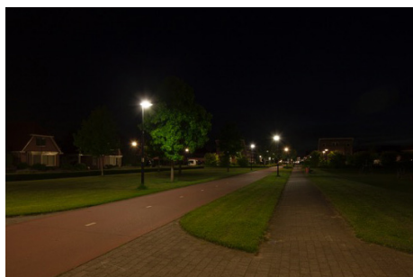
Foto: Woonwijk De Munten II; woonwijk op PKVW-niveau. Er staat volop licht. Als proef is een deel van het licht uitgezet. Dit levert een energiebesparing van circa 70% op.
