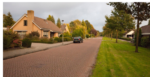
Foto: Keplerlaan in Dronten, voorbeeld van een erftoegangsweg
