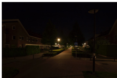
Foto: Woonwijk De Munten II; woonwijk op PKVW-niveau. Er staat volop licht. Als proef is een deel van het licht uitgezet. Dit levert een energiebesparing van circa 70% op.
